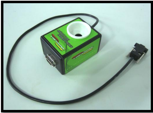
Cabo MCU. Faz leitura e programação de memórias e microcontroladores através de solda diretamente na placa.
