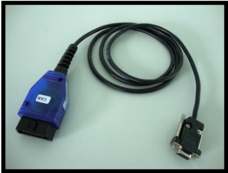
Cabo Fiat. Utilizado para alimentar o módulo de transponder no veículo.
